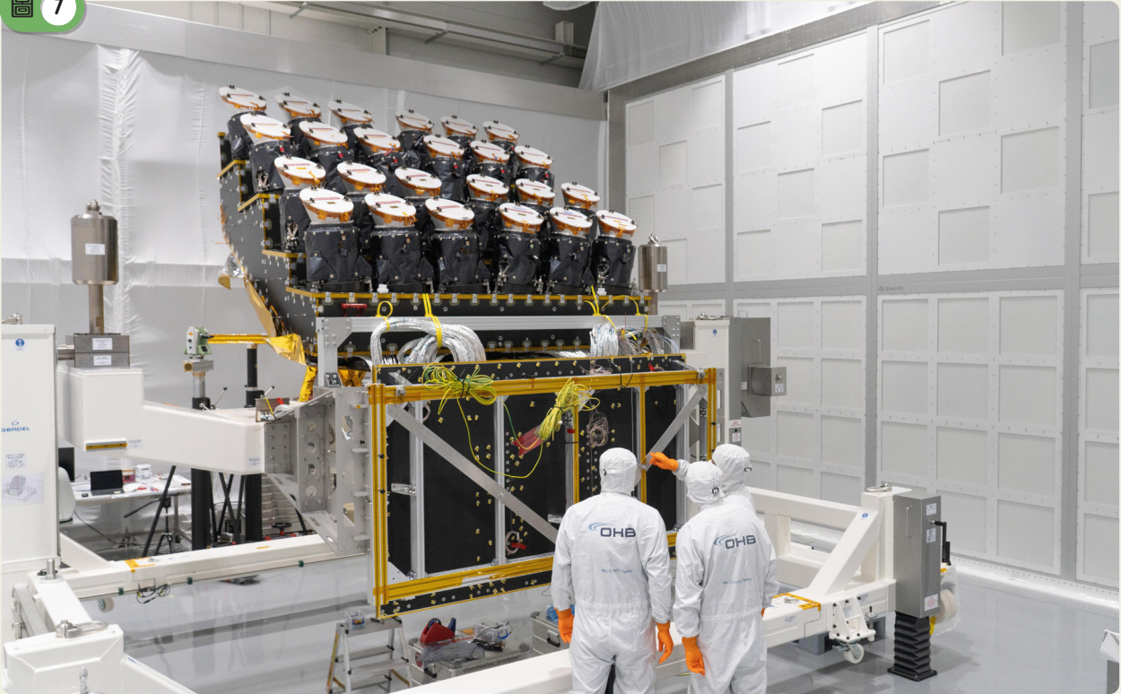
柏拉圖任務的太空探測器上，配置了靈敏的「26眼」觀測系統，工程師正將這些相機安裝在探測器的光學平臺上。影像來源：ESA
