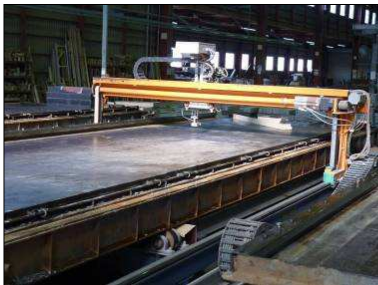
圖45 電腦化放樣作業（作業精準、減少人力）。
