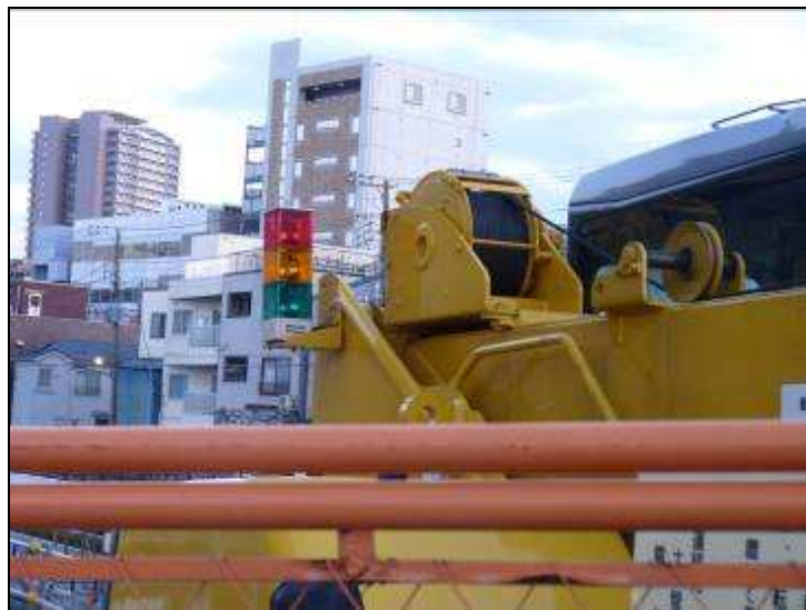
圖79 挖土機之旋轉警示燈（採紅、黃、綠三種燈號更易達到警示效果）。
