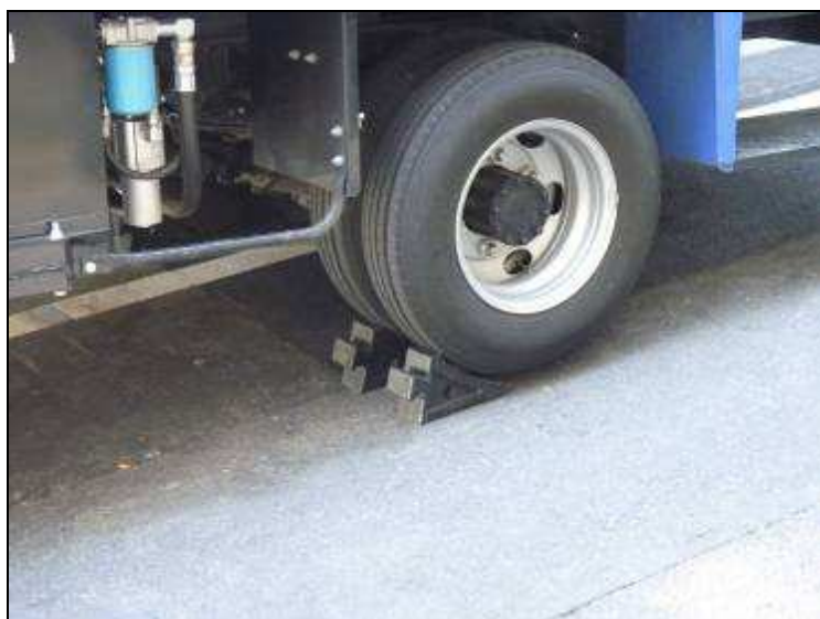
圖26 施工車輛使用之安全輪擋。
