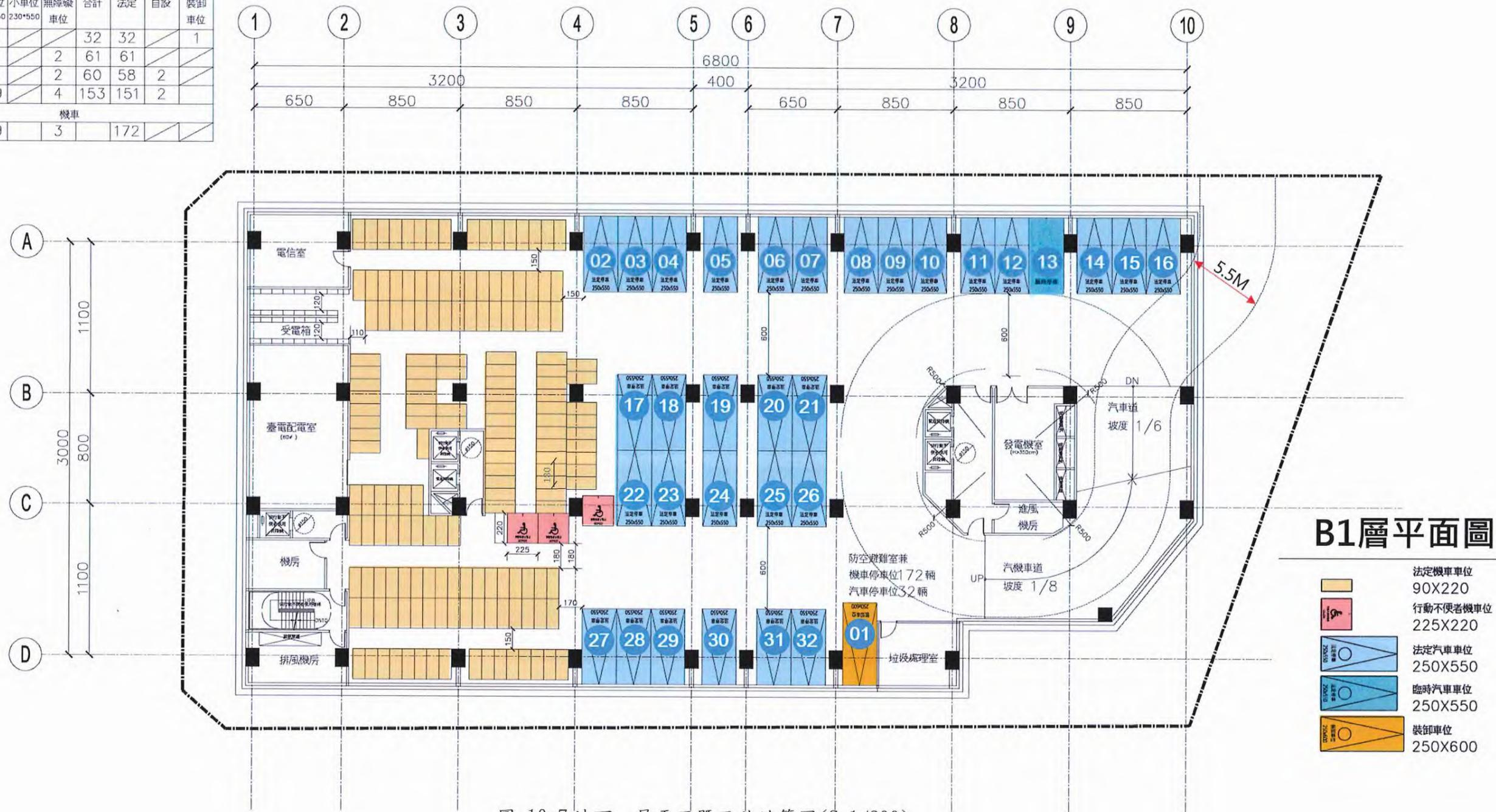
圖 10-7 地下一層平面暨面積計算圖(S:1/300)
