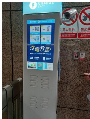
圖二：捷運站的 ChargeSPOT 機台設置位置原為免費提供民眾使用的充電站，因此機台也於左側提供免費充電線。
