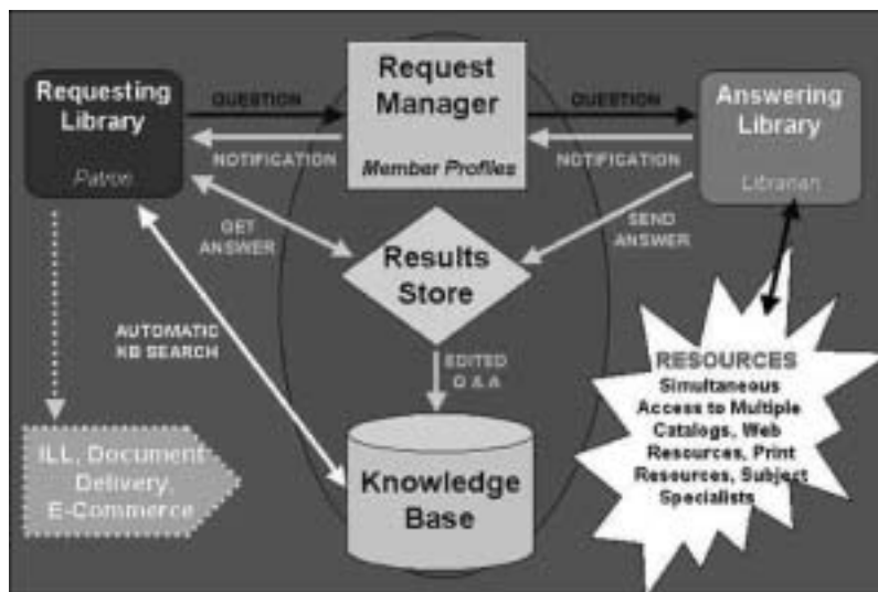
圖1 QuestionPoint 運作流程示意圖 (From OCLC)
