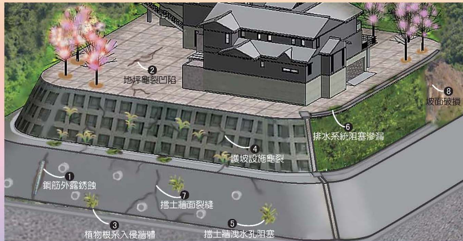
1 鋼筋外露銹蝕
