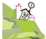
房屋緊鄰陡峭邊坡與邊坡退縮距離不足
