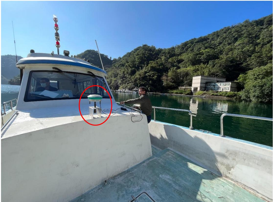
測量作業船艇安裝 GPS，定位座標，確保測量航路正確
