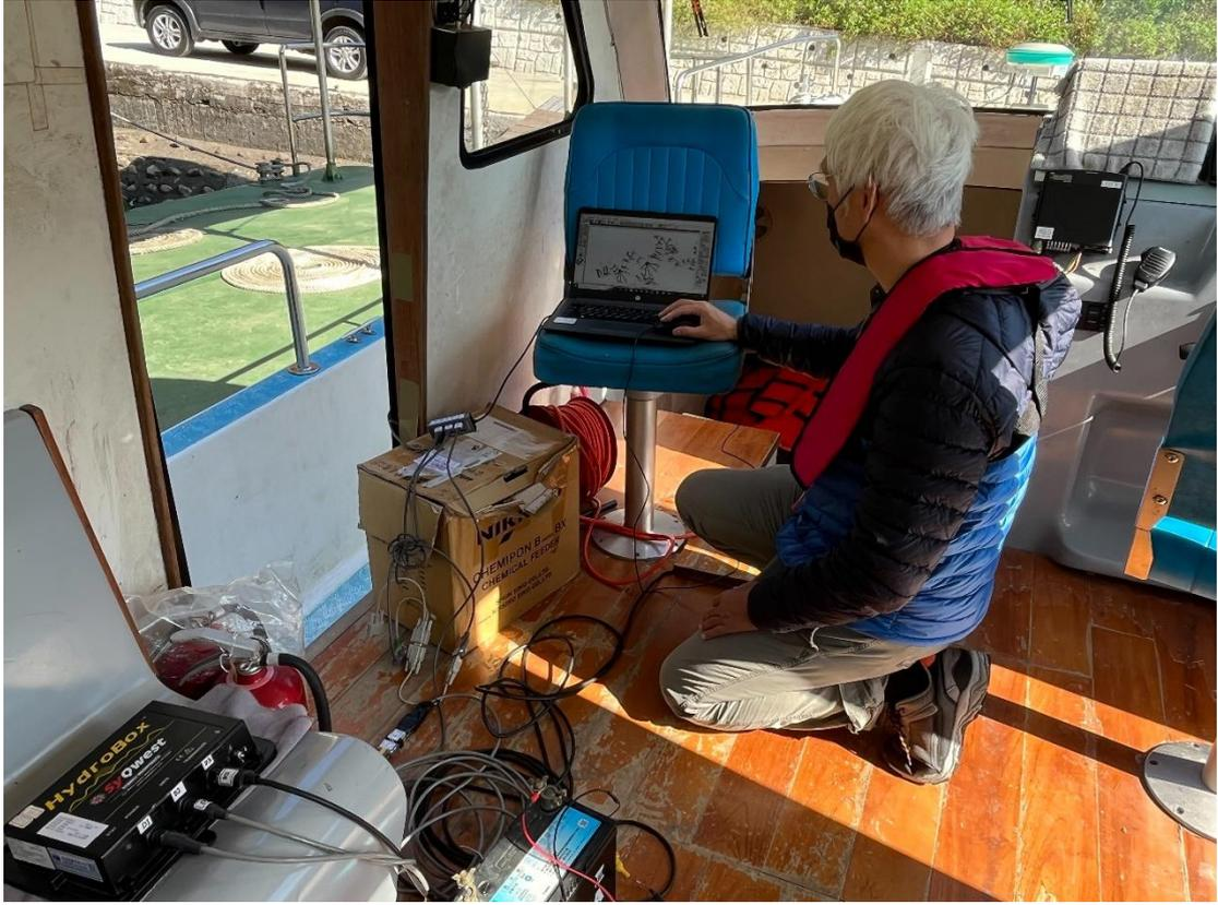
測量作業船上測量音鼓及記錄測試
