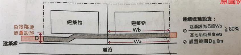
圖7 連續遮蓋設施配置示意圖
