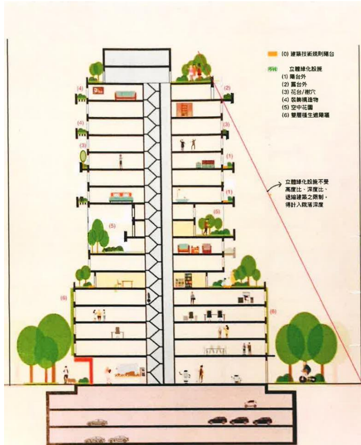
圖6 立體綠化設施設置示意圖
