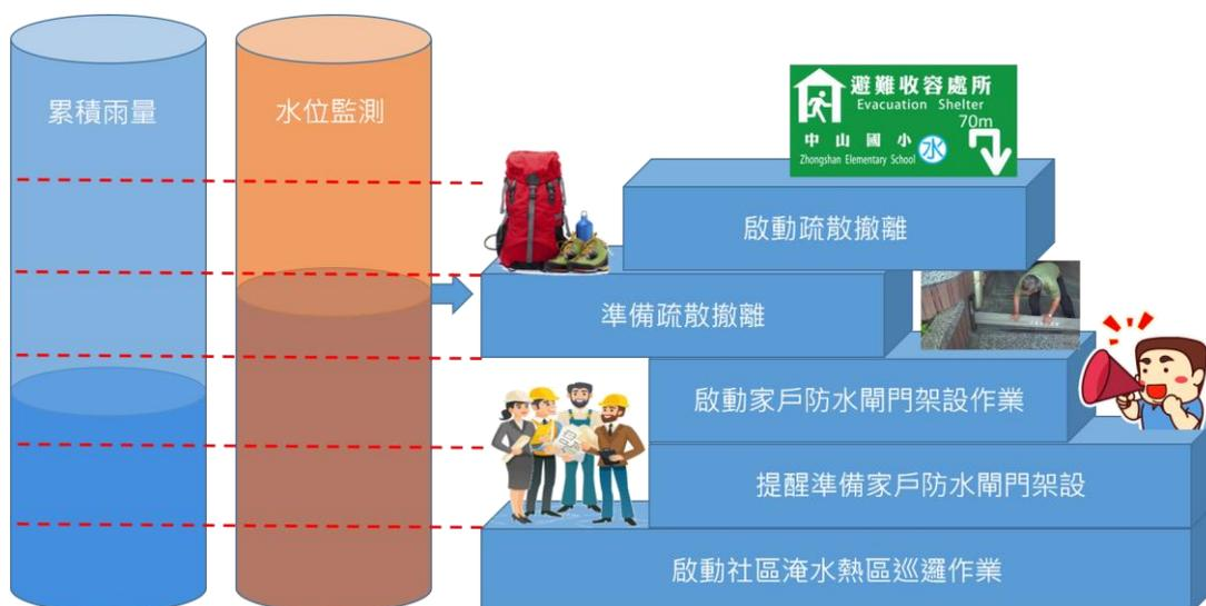
圖 3.3 搶救作業機制示意圖
