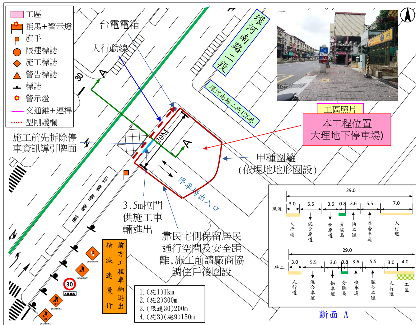
施工交通管制設施佈設示意圖
