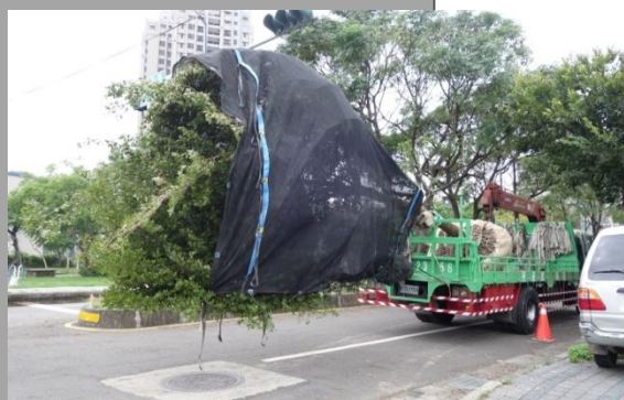
先估計樹木整體吊搬總重量以選擇安全有效機具
