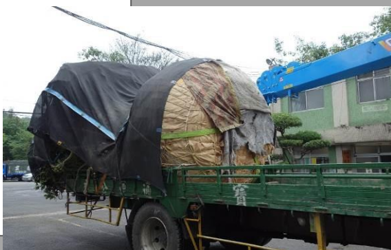
先估計樹木整體吊搬總重量以選擇安全有效機具
