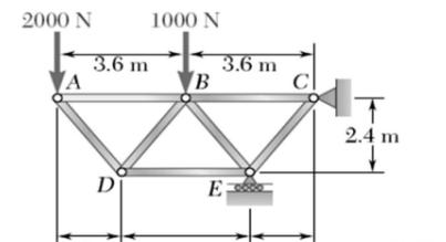
【4】17.如右圖中的桁架(truss)結構，B 處受到 800 N 的力，桿件 BC 的受力情形為何？
