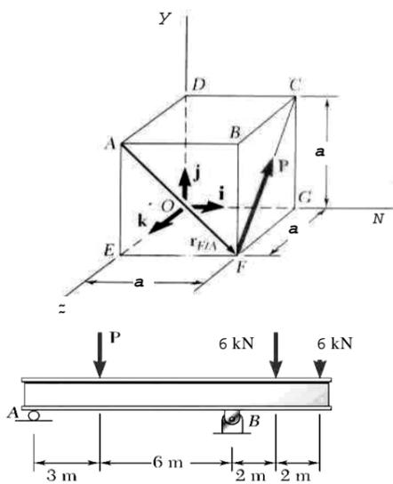
【1】5.右圖中的樑結構受到三個垂直負荷，支撐點 B 處的水平反應力 (reaction force) 為何？
