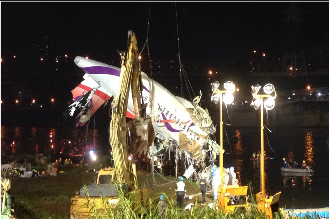
吊車將機尾吊至岸邊
