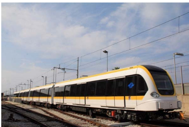
環狀線電聯車車頭採20度流線造型
