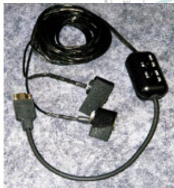
圖 4.6 皮膚電阻感測器
