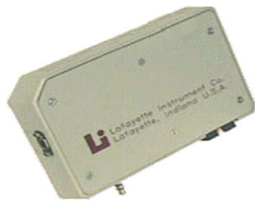
圖 4.5 Biopotential 訊號放大器
