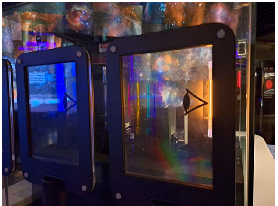
圖5. 從偏光片約45度角斜看，現場陳列的4組元素燈會有不同特徵的發射光譜。圖為氫氣燈所發出的發射光譜。
