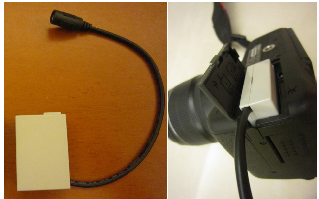
圖6. 單眼相機可利用假電池及連接線與外接電源連接。
