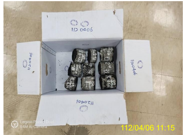
4、試體放入箱子內後未封箱前照片(要能清楚拍到工務所/分隊所做編號戳記)。
