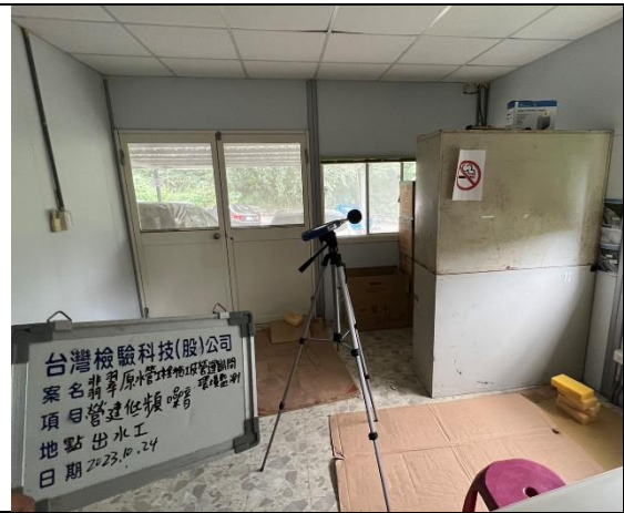
低頻噪音(出水工)
