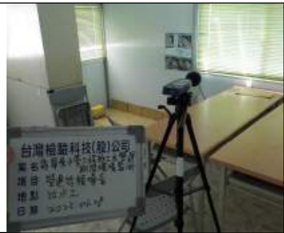
低頻噪音(出水工)
