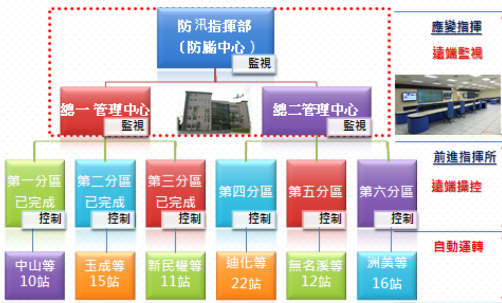
圖 1 臺北市抽水站自動化監控系統架構
