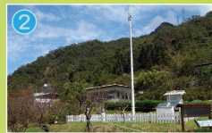
2 綜合氣象站 監測蒐集水庫氣象資料，如風速、風向、氣壓、日照量、日照量、相對濕度、氣溫等，系統使用太陽能並以無線電傳輸方式，將資料送至運轉中心，做為水庫操作運轉之基本資料。
