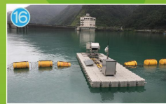
16 大壩分層水質監測系統 每小時自動進行濁度、溶氧量、酸鹼值、懸浮固體物、導電度、水溫、電阻率等7日水質監測。依據系統監測結果，配合不同標高的放水設施，可即時排放濁度較高水體，以降低水庫淤砂量與維護水庫良好水質。
