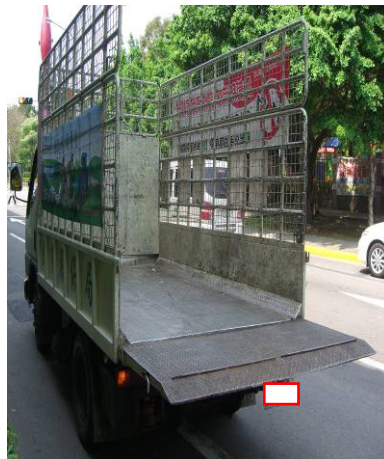
說明：肇事車輛後車斗護欄未關閉。
