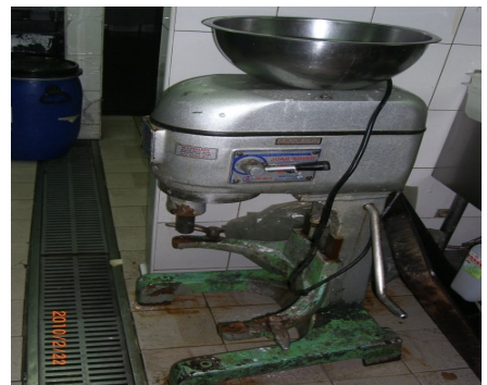
說明：攪拌機未裝護具情形。
