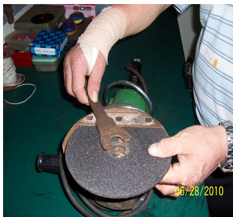
說明：肇事人持扳手鎖緊砂輪片中心圓孔處予以固定。
