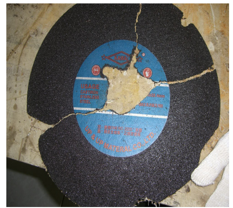
說明：砂輪片爆裂成 3 塊事後組合。
