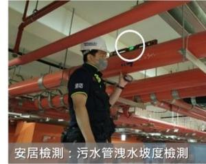
安居檢測：污水管洩水坡度檢測
