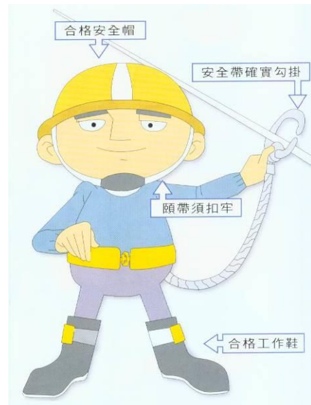
說明：進行營繕作業需正確戴用合格安全帽及安全鞋並配掛安全帶。
