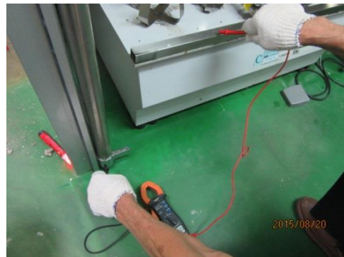
說明：職災現場感電模擬測試。
