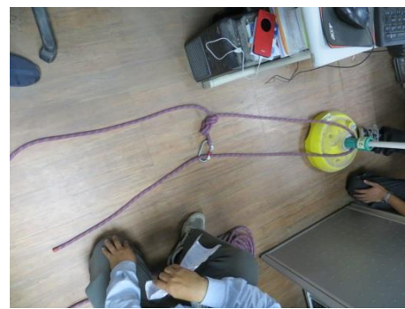
說明：模擬疑似繩索固定方式(救命繩未用且工作繩受力，致使繩索鬆脫)。
