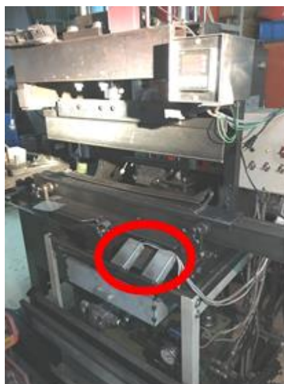
說明：上下開關無標示（紅圈處，左下右上），機臺無任何安全裝置。
