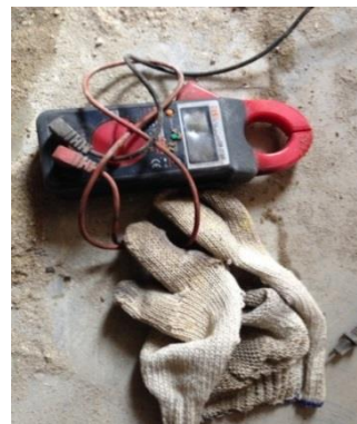
說明：受傷勞工所戴棉質手套及使用電表。(電表已被高壓電燒壞)
