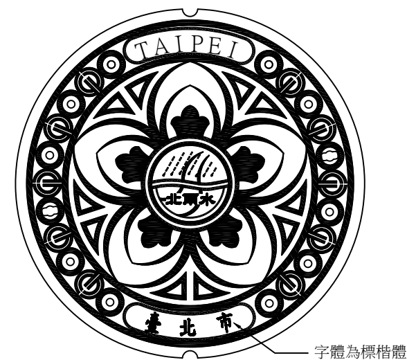
鑄鐵人孔蓋表面式樣 9 A1 (1:5) A3 (1:10) Unit:cm
