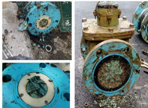
圖 1 粉體塗料脫落導致堵塞水表
