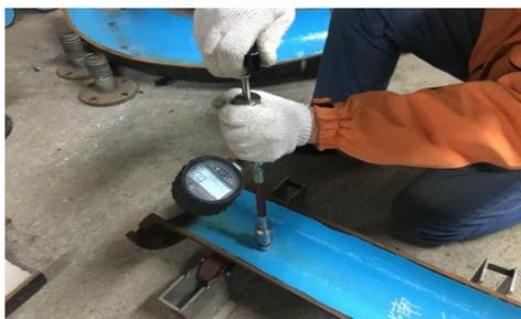
圖 5 DIP 粉體管拉拔試驗
