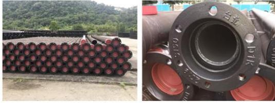
圖 7 塑膠蓋封口 DIP 粉體管
