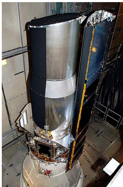
史匹哲太空望遠鏡，鏡筒面向太陽的那一側漆成銀色，另一側則漆成黑色的。圖片來源：wi-ki
