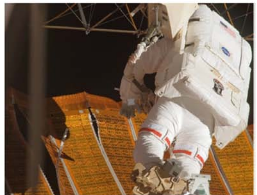
左：太陽能板撕裂處的特寫，中：太空人站在機械臂上靠近損壞處，右：接近撕裂處進行修復。
