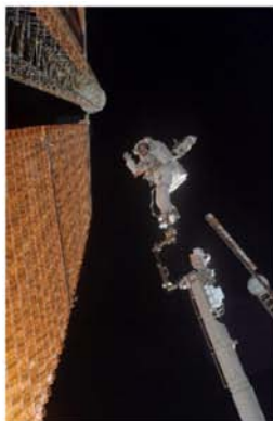
左：太陽能板撕裂處的特寫，中：太空人站在機械臂上靠近損壞處，右：接近撕裂處進行修復。
