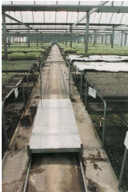
圖 10.46 四輪軌道車在育苗中心作業之情形(民雄育苗中心)
