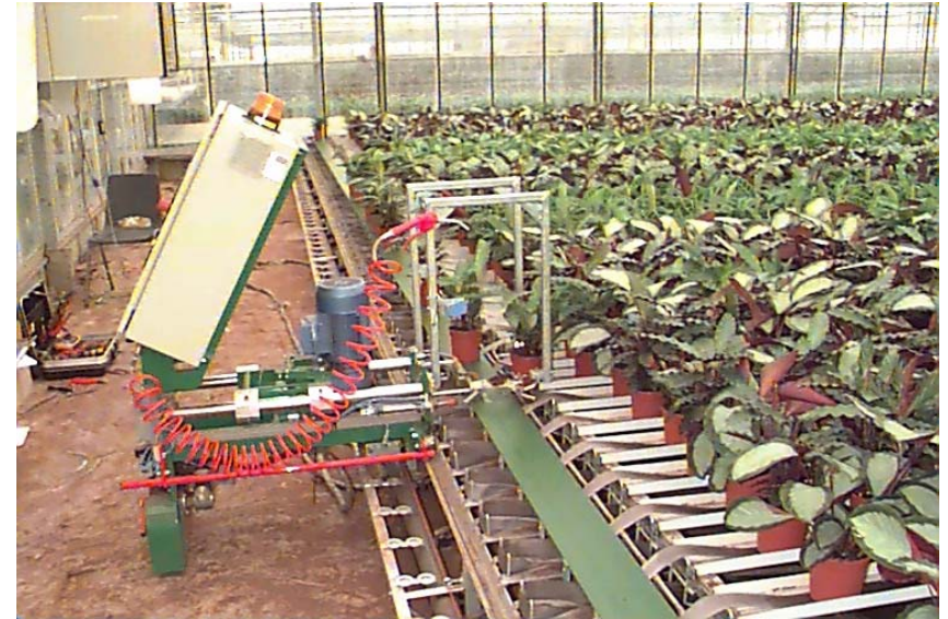
圖 10.59 平皮帶運送機，荷蘭用以輸送盆花
