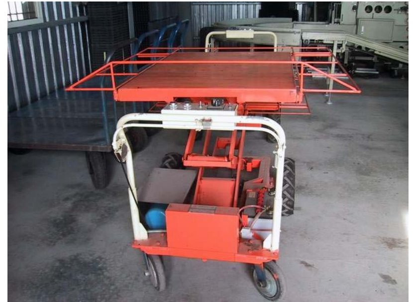
圖 10.54 植床頂部台車之搬運車(茂盛育苗場)
