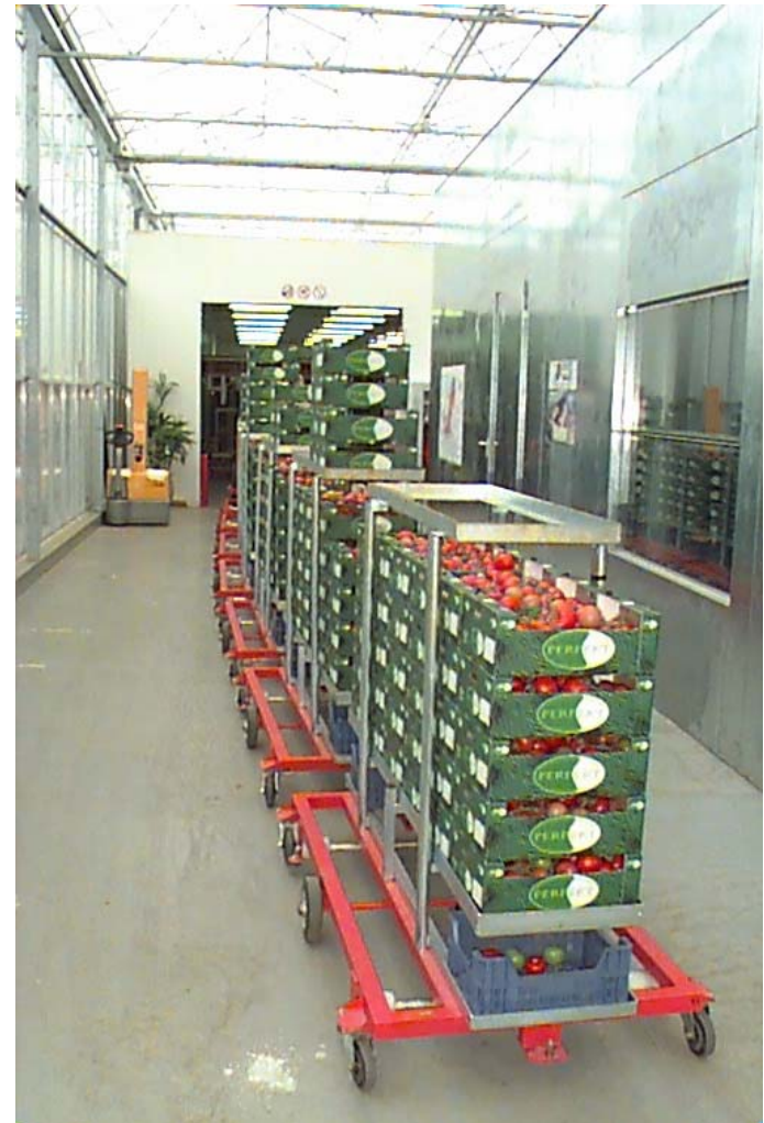
圖 10.45 利用曳引車帶動多輪連結車進行搬運(番茄)
