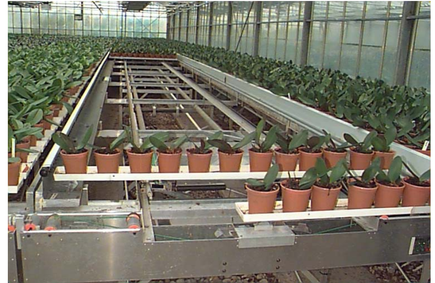
圖 10.70 槽床式搬運系統可以使植栽受到個別照顧(荷蘭)
