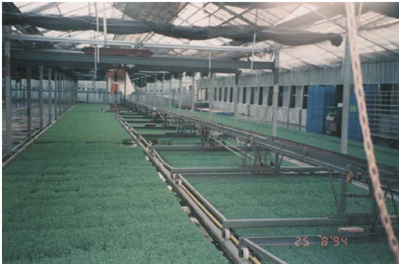
圖 10.58 三角皮帶連成之遠距輸送機(福田豆苗場)
