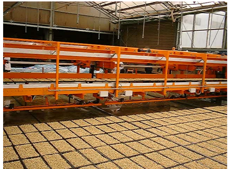
圖 10.68 自動卸取箱設備可以將豌豆苗盤平放及自地上取出(福田豌豆苗場)
