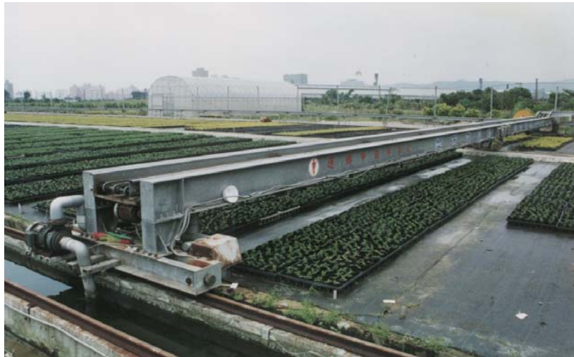
圖 10.66 利用空中輸送機架設於田間軌道，可供搬運及噴水的工作(花之鄉)
