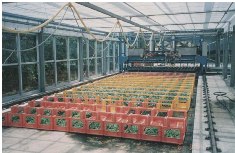
圖 10.67 由台大及桃園場研發的子母車自動搬運系統(桃園場)
