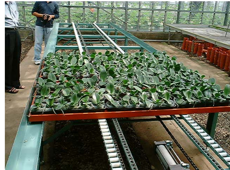
圖 10.63 利用鍊條驅動槽床將盆花進行中間處理(新台灣溫室)
