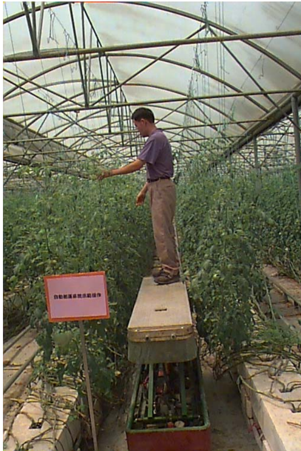
圖 10.71 番茄園中使用之高度可調式工作車(亞太農場)
