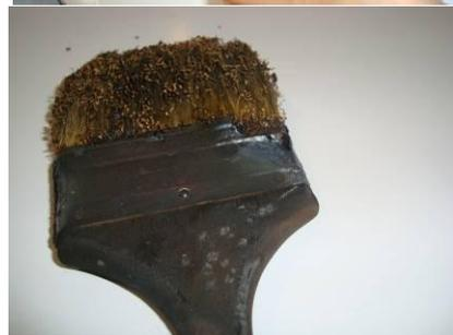
說明：油漆刷與匯流排短路造成熔斷。
