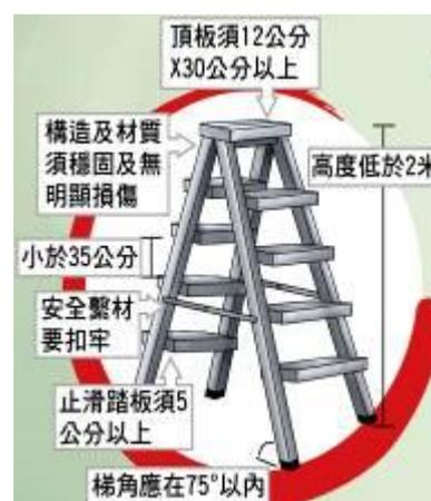
說明：雇主對於使用之合梯應具有(1)頂板須 12 公分x30 公分以上。(2)構造及材質須穩固及無明顯損傷。(3)每一踏板垂直間距須小於 35 公分。(4)連接梯腳之安全繫材要扣牢。(5)止滑踏板須 5 公分以上。(6)梯腳應在 75 度以內。(7)高度低於 2 公尺。
