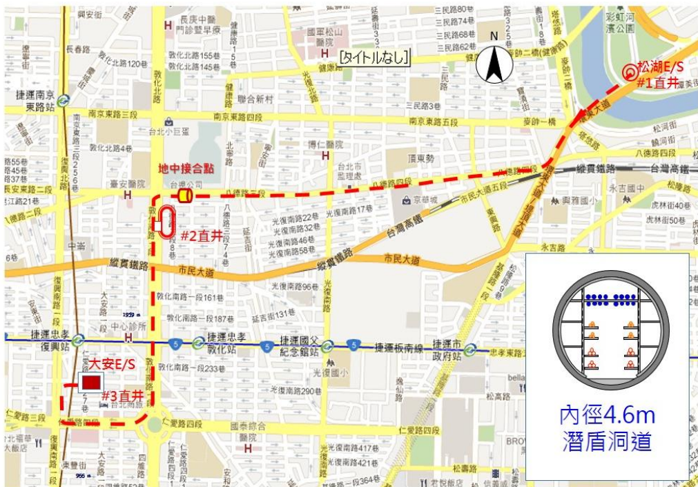
圖一 臺電大安 345KV 電纜線路平面圖
