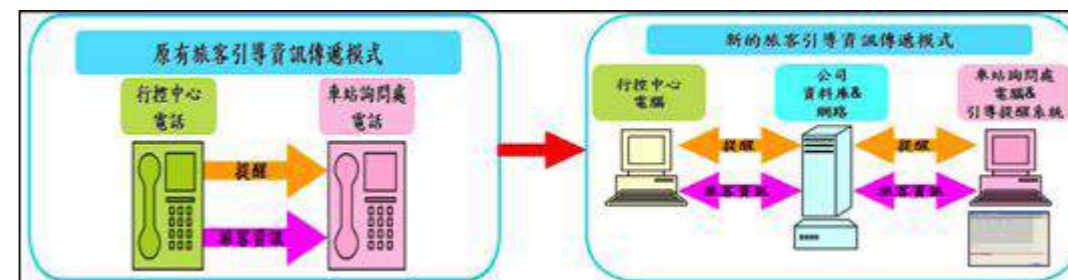
圖四、車站引導服務提醒系統運作原理
