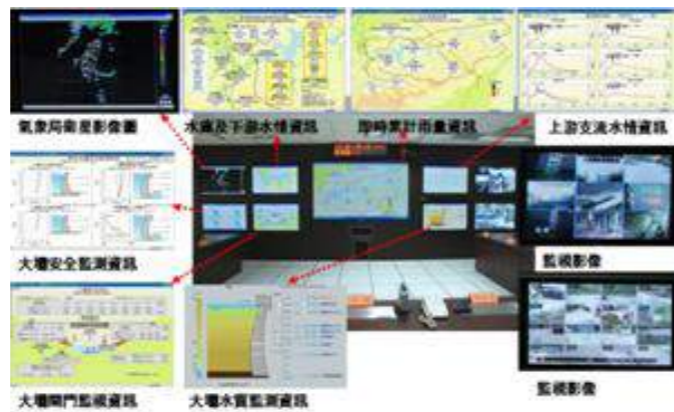
圖三 翡翠水庫運轉中心資訊整合及決策系統示意圖
