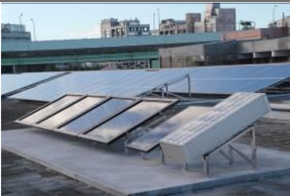
圖五：不同透光濾及材質之太陽能板
