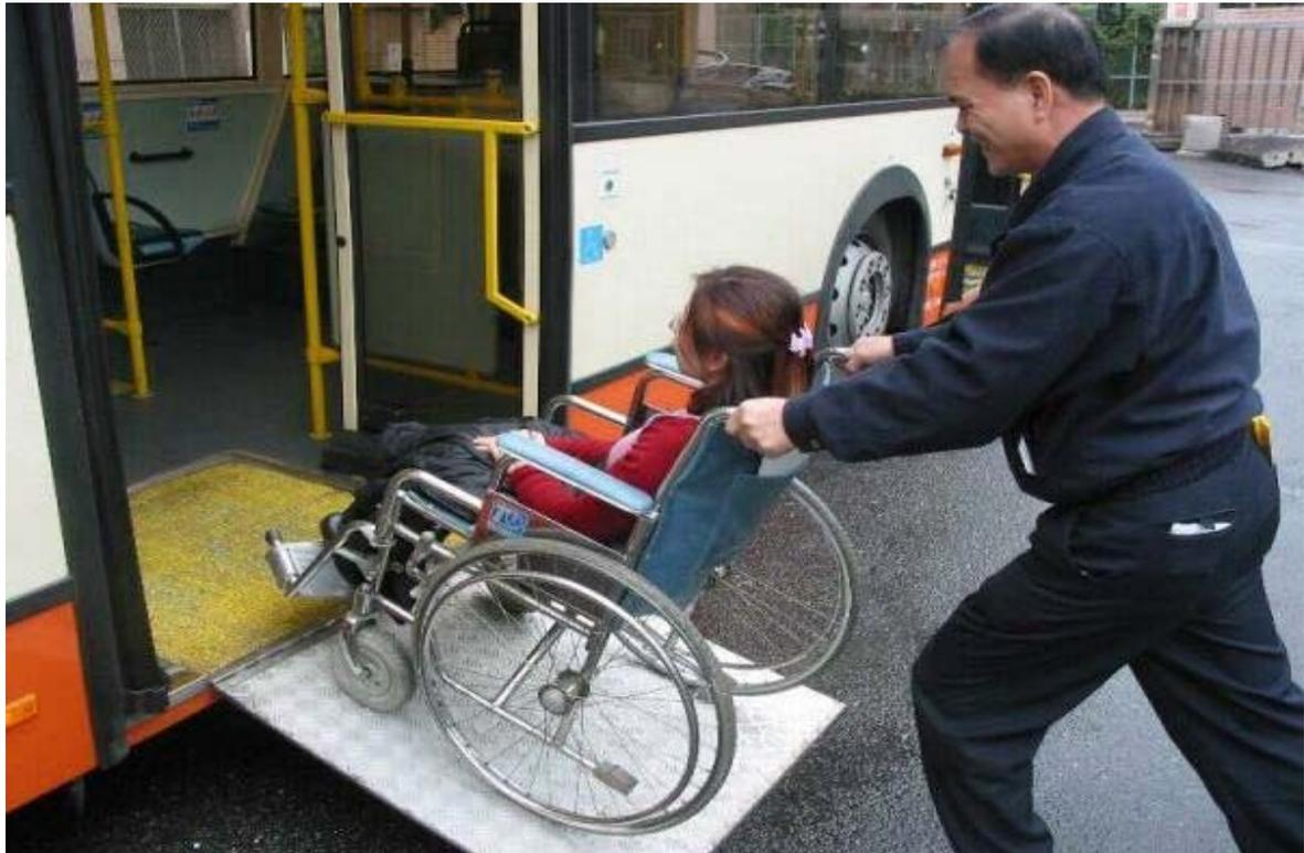
照片 8、低底盤公車車內採「無階梯」設計、具有斜坡板，可方便輪椅及推車進出。
