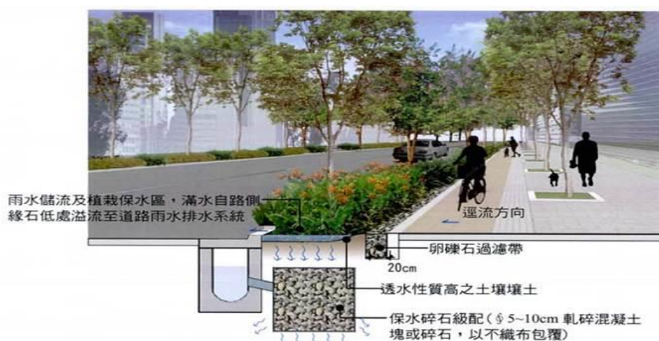
人行及自行車道側滲透式帶狀植栽槽剖面示意圖
