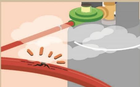
每次更換瓦斯桶時，應檢查橡膠軟管是否老化、龜裂或破損。
