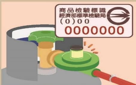
壓力調整器、橡膠軟管應符合國家標準，並附加商品檢驗合格標示。
