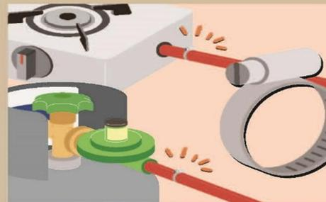
橡膠軟管與壓力調整器及瓦斯爐具銜接處以安全夾夾緊並檢查是否漏氣。
