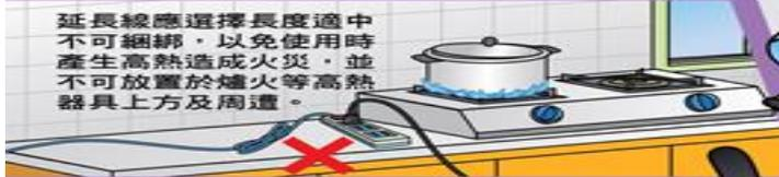
用延長線應有過載自動斷電功能，避免同時使用，並分別插在不同插座。
