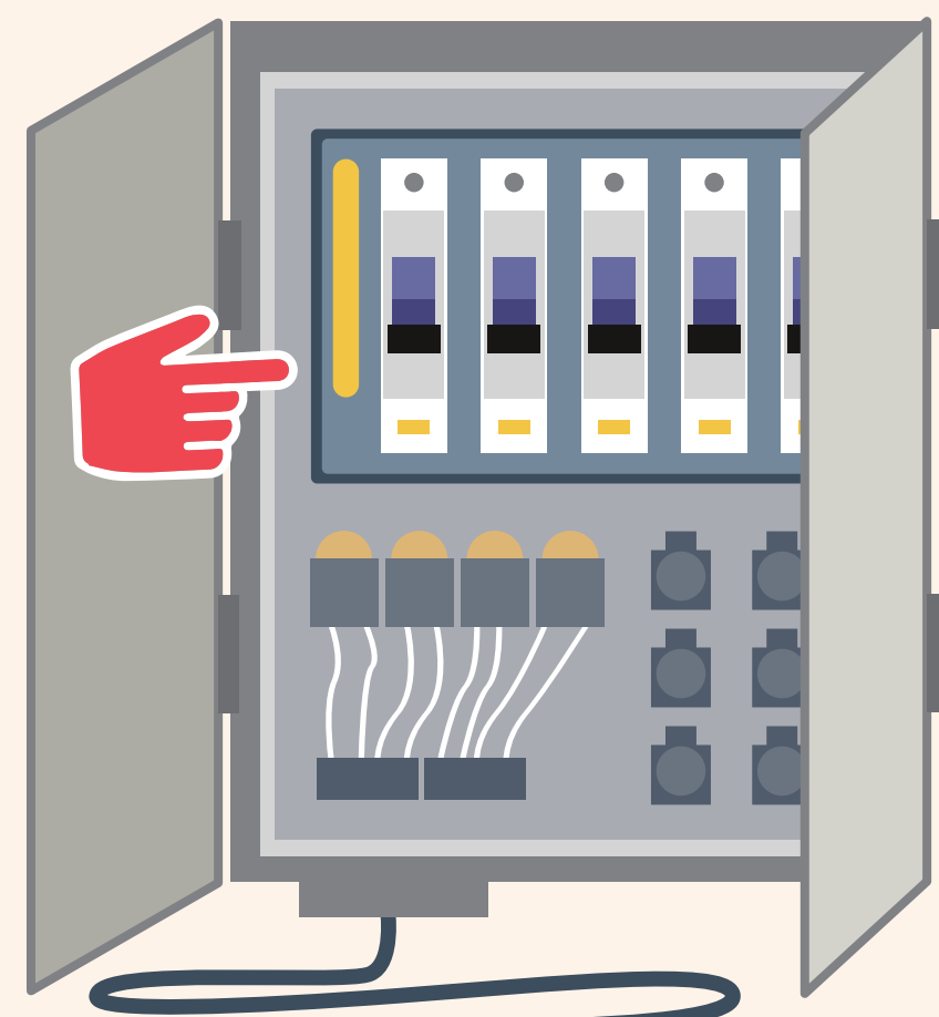
電動機具需加裝 漏電斷路器
