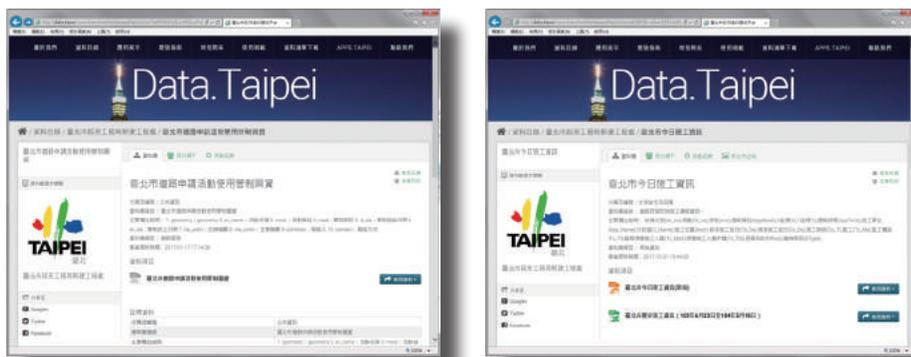
(3)道路施工通報APP：利用智慧通訊工具即時回報施工現況及復舊品質，針對管線施工相關資訊(埋設位置、管材、深度)、管線障礙、淺埋管線進行結構補強、管溝回填初凝情形等列為施工檢驗停留點，要求現場定位拍照上傳功能，將如實紀錄現況，以利稽核並對施工過程紀錄，提供即時追蹤、重點管理及品管查考，並可作為後續管線圖資應用之依據。
