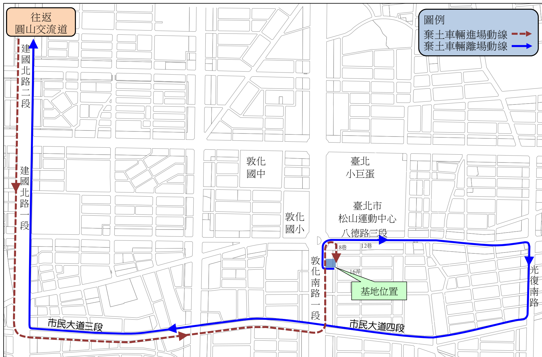
圖7-9施工運輸與運土車輛路線
