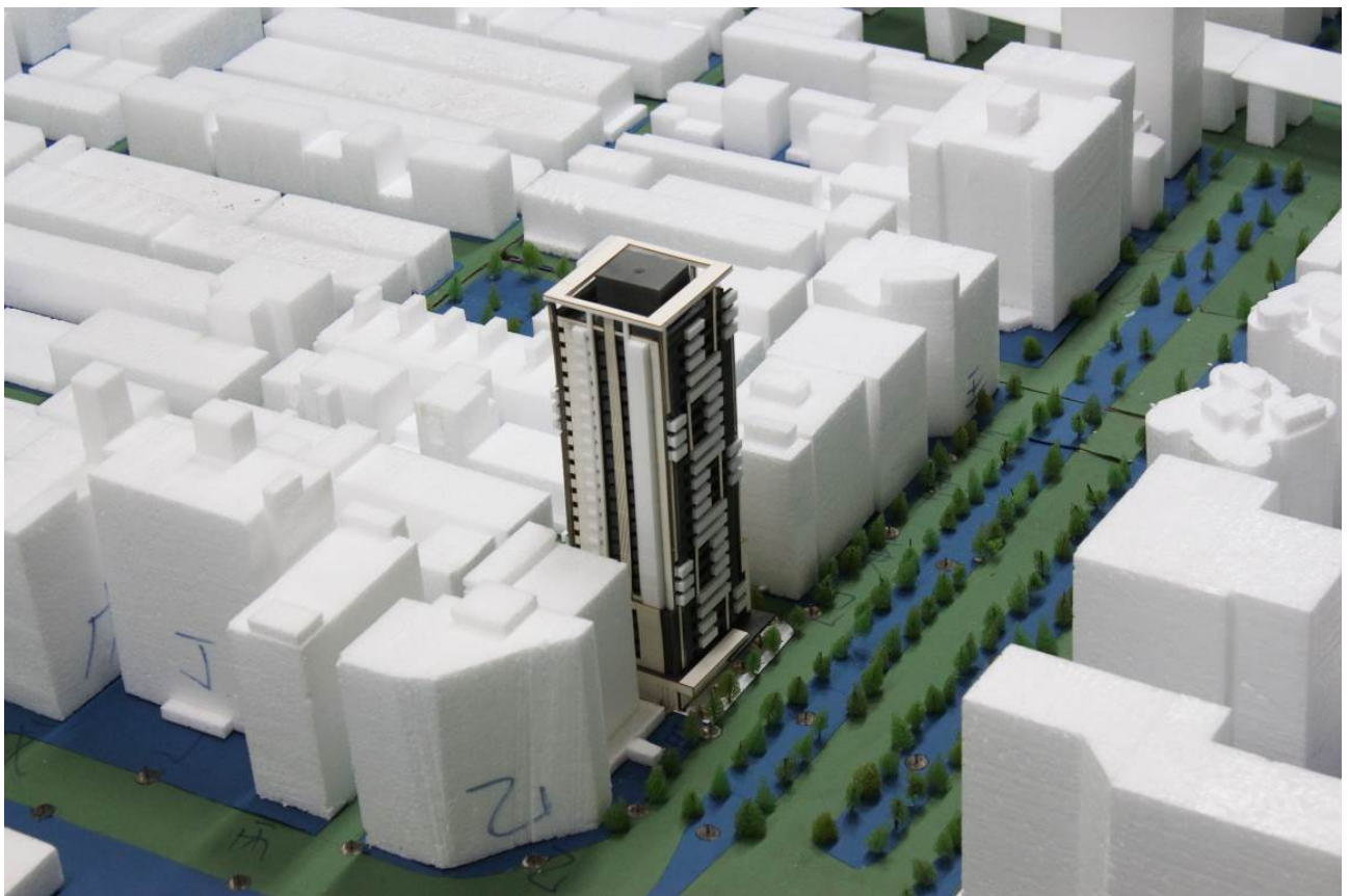
圖7-12 風洞試驗主模型
