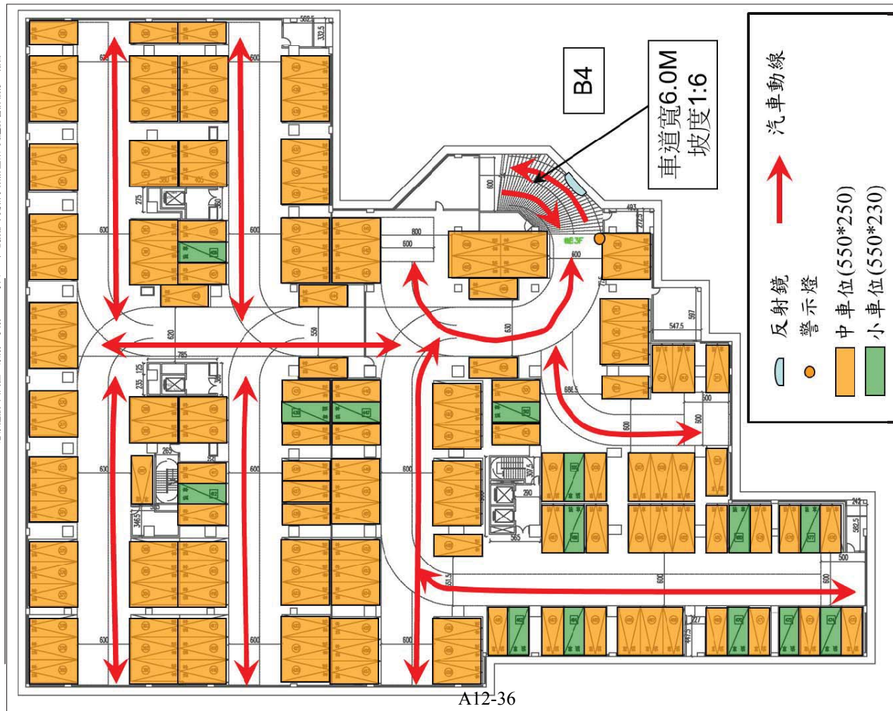
圖 5-7 基地地下四層車輛動線示意圖
