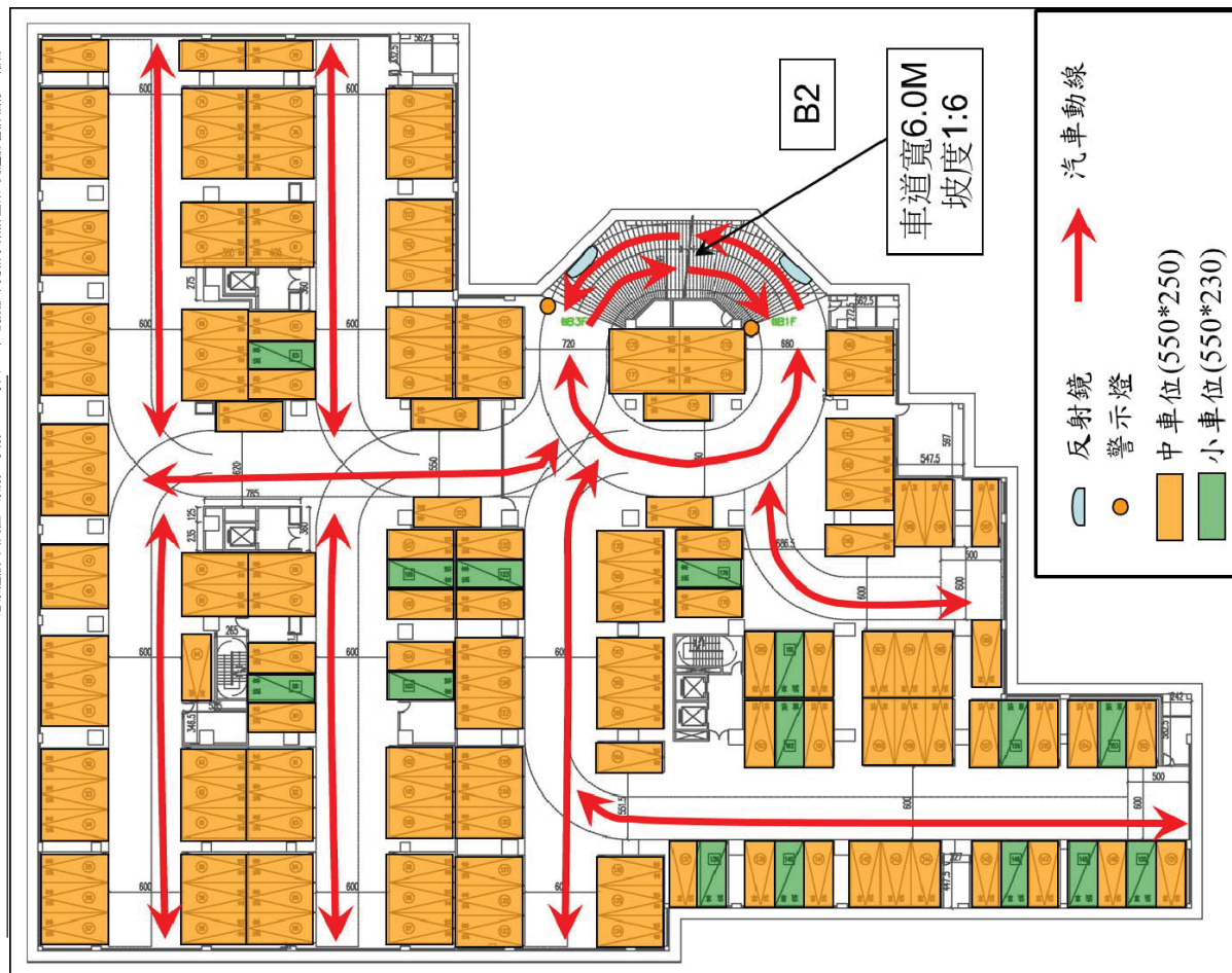
圖 5-5 基地地下二層車輛動線示意圖
