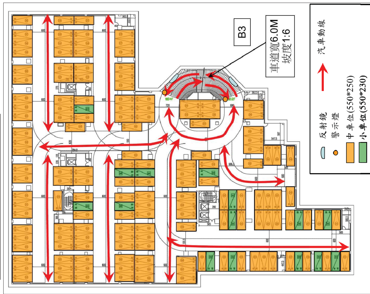
圖 5-6 基地地下三層車輛動線示意圖
