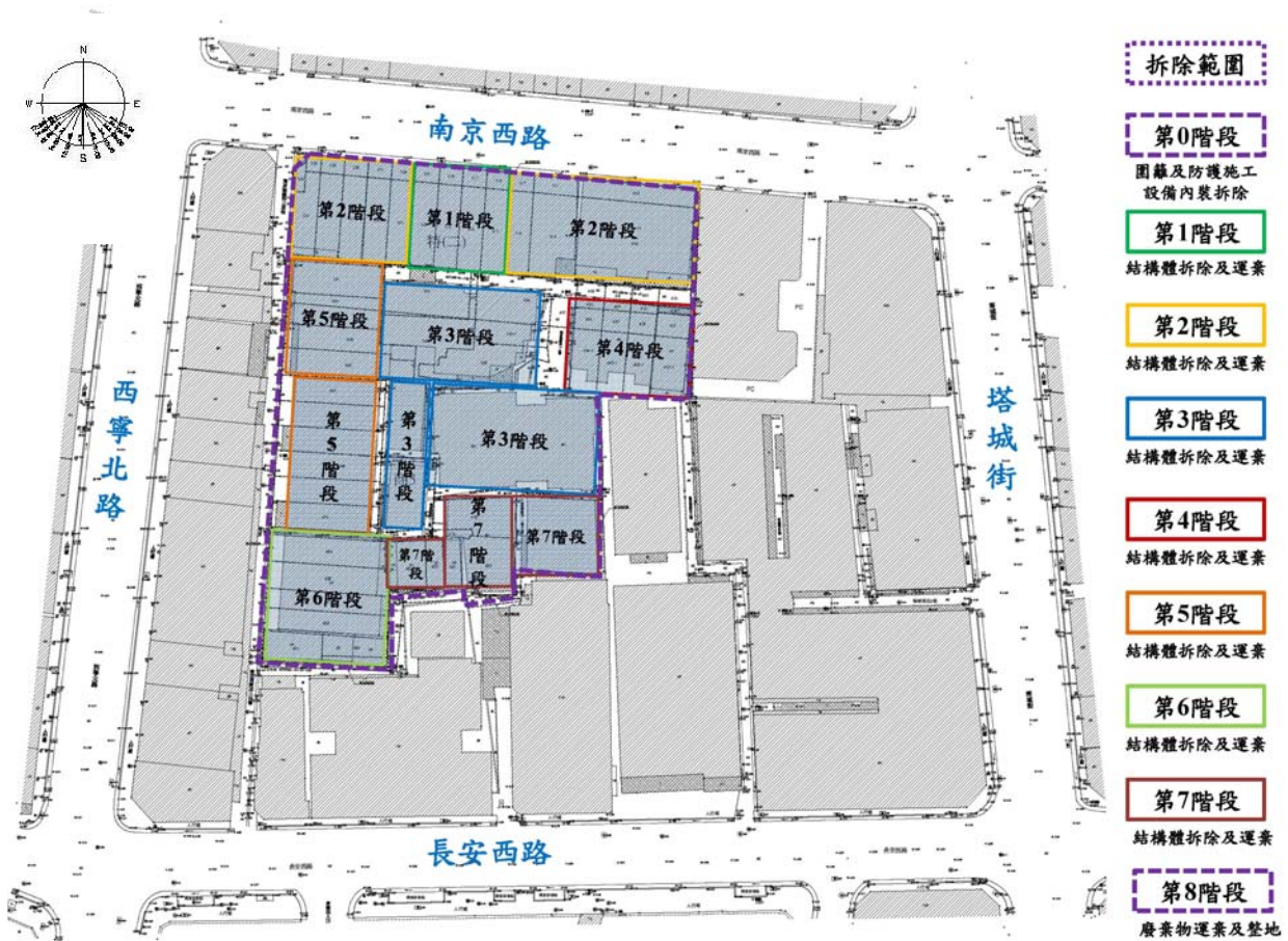
圖7-8基地既有建物拆除順序示意圖
