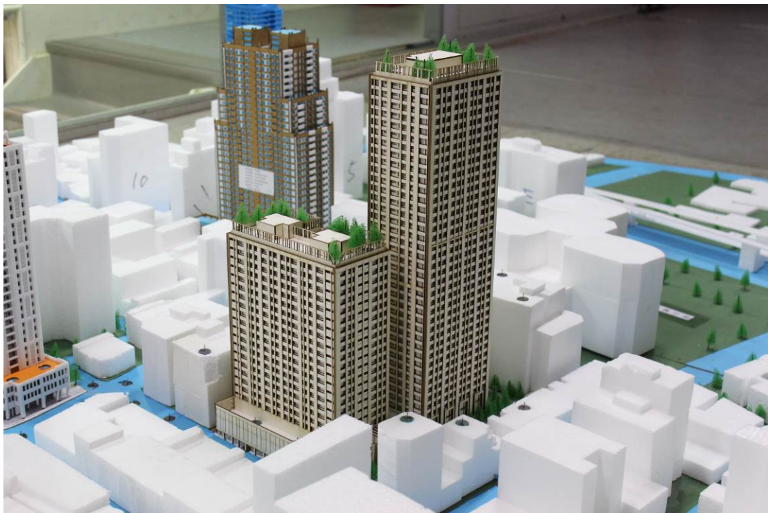
圖7-15 風洞試驗主模型
