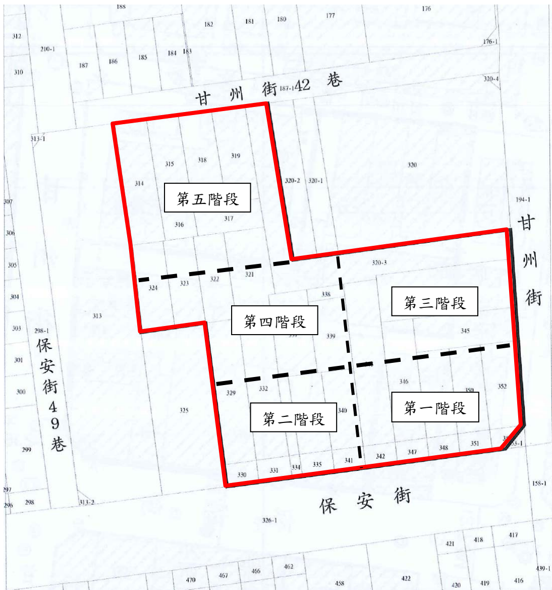
圖7-8 基地既有建物拆除順序示意圖
