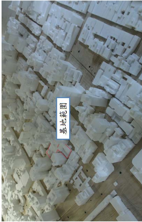
圖 3.14 原建物地表風速計安裝於基地周圍情況
