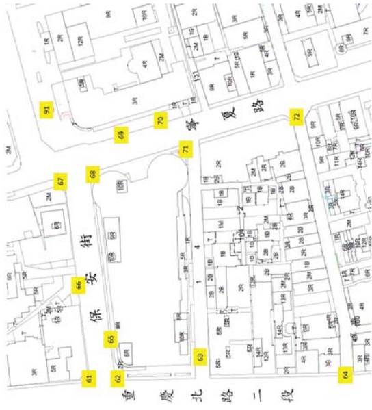
圖 3.12 原建物與新建物基地東側地表風速計安裝位置與相對應編號
