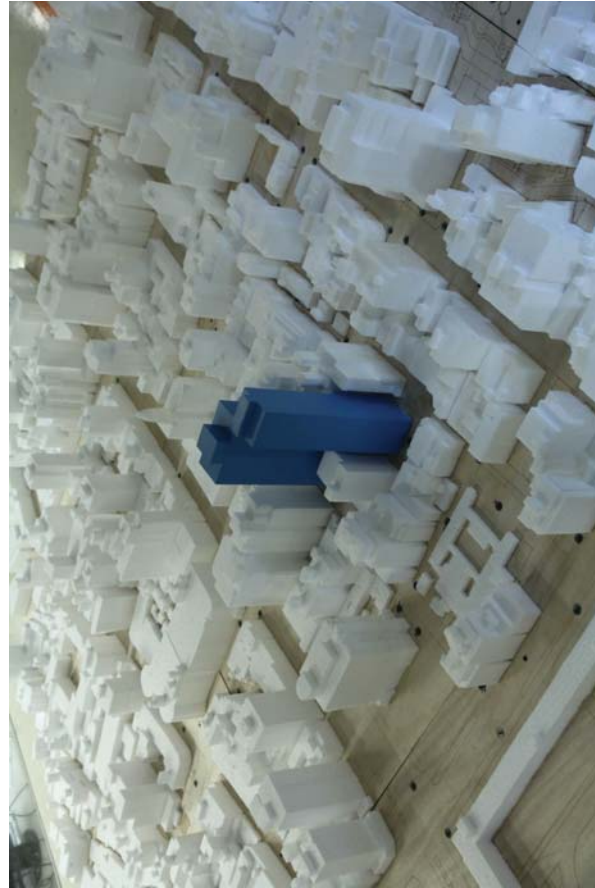
圖 3.15 新建物與地表風速計安裝完畢照片
