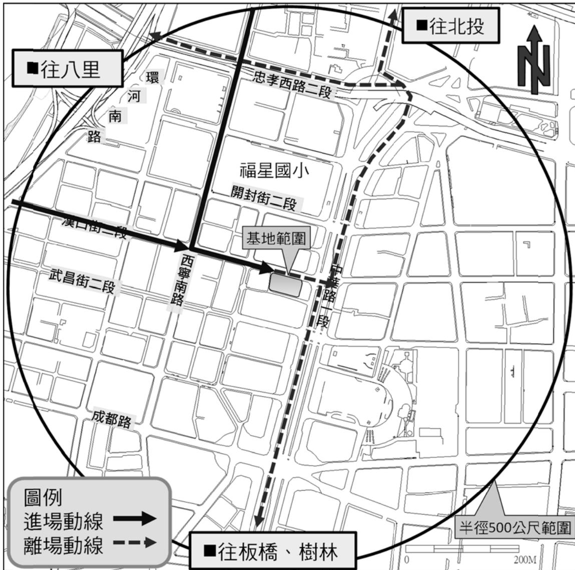
圖 5.7-2 基地工程車輛進出動線規劃示意圖
